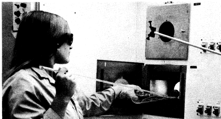
LOADING DIFFUSION FURNACE
